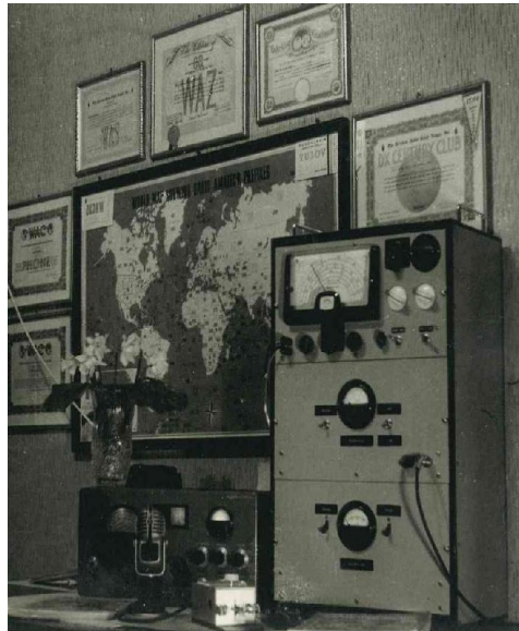
Bojanova postaja leta 1962: sprejemnik Hallicrafters SX-43, oddajnik z VFO Geloso in 50 W končno stopnjo (elektronka 807)
