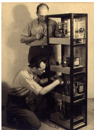
Gradnja srednjevalovnega oddajnika za 204,2 m, kleči Stanko Vajngerl
